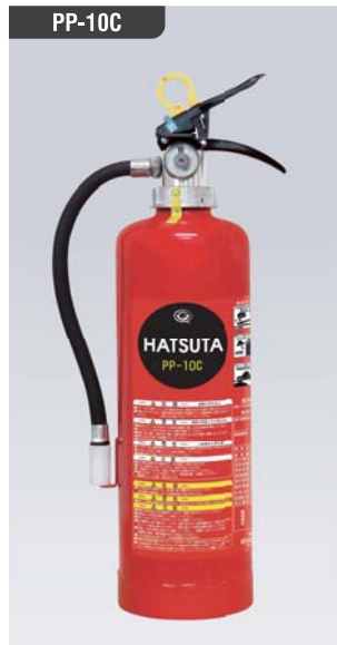
蓄圧式(粉末ABC)消火器 総重量：約5.0kg 放射時間：約15秒 放射距離：3~6m
