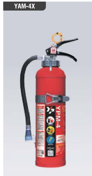
自動車用消火器 総重量：約3.57kg 放射時間：約12秒 放射距離：4~6m
